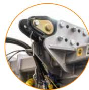
**Регулируемые противоножи из стали Hardox®** для эффективной регулировки крупности частиц
